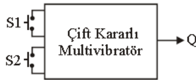
Şekil 1.8: Çift kararlı multivibratör blok şeması
