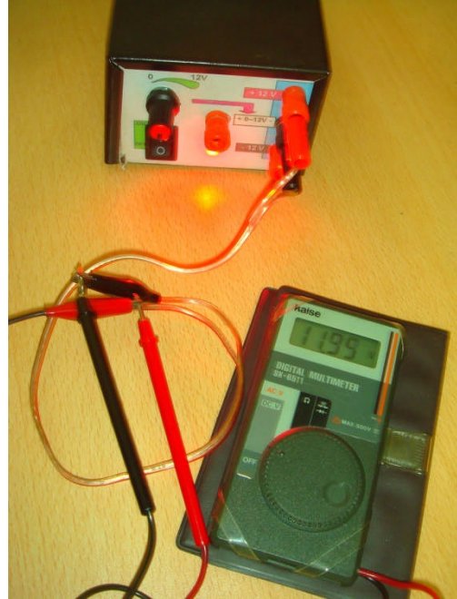
Resim 5.3: Güç kaynağının +12V ve -12V çıkışı
