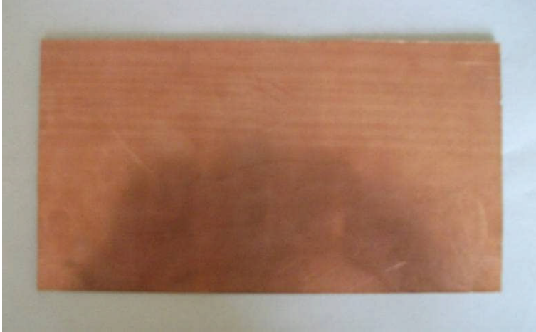
Resim 2.3: Yüzeyi temizlenmiş baskı devre plaketi
