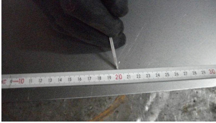
Resim 1.3: Güç kaynağı sacının ölçülmesi
