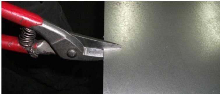
Resim 1.5: Güç kaynağı sacının sac makası ile kesilmesi
