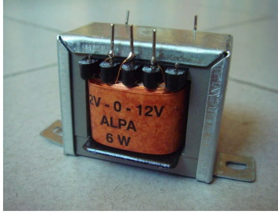
Resim 1.1: 6W 2x12V transformatör
