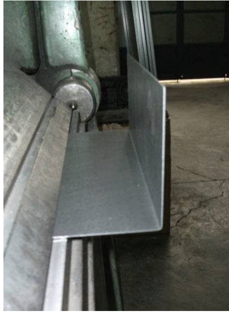
Resim 1.8: Güç kaynağı kutusunun caka yardımı ile bükülmesi
