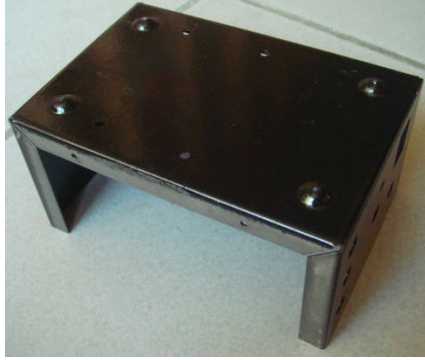
Resim 1.11: Güç kaynağı kutusunun gövdesi (alttan görünüş)
