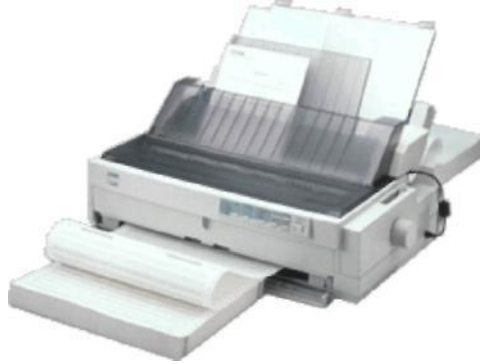
Resim 1.1: Nokta vuruşlu yazıcı ve sürekli form kağıdı
