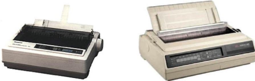
Resim 1.7: Dark kolon ve geniş kolon nokta vuruşlu yazıcılar
