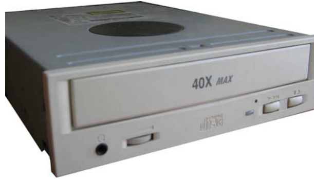
Şekil 3.6: 40X veri okuma hızına sahip CD-ROM sürücü
