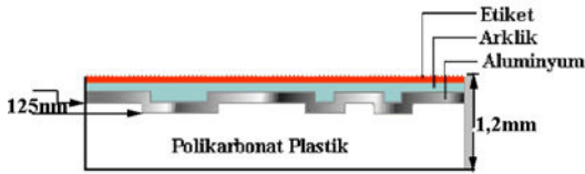
Şekil 3.2: Veri kaydı yapılmış CD-ROM'un malzeme yapısı
