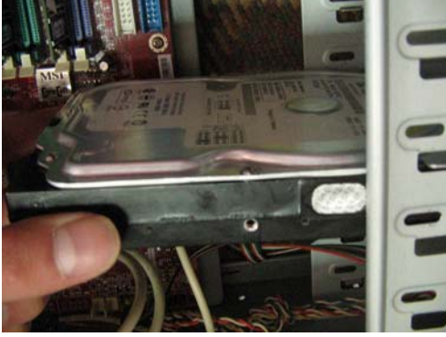
Şekil 1.43: Sabit diskin kasa içine yerleştirilmesi
