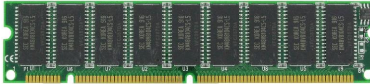
Resim 1.19: 168 pin DIMM bellek
