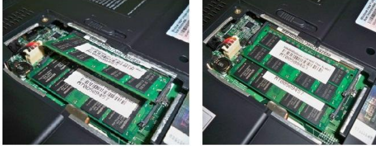
Resim 2.13: SO-DIMM RAM yuvası
