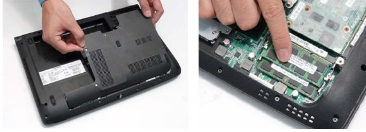
Resim 2.12: SO-DIMM RAM montajı
