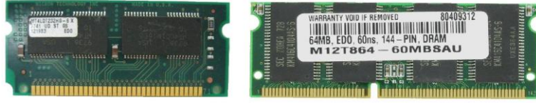
Resim 1.22: 72 ve 144 pin SO-DIMM'ler
