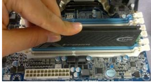
Resim 2.10: DIMM RAM slotunu bastırma iřlemi
