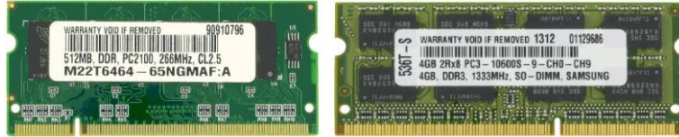
Resim 1.23: 200 ve 204 pin SO-DIMM'ler
