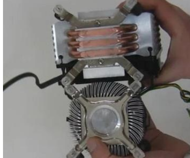
Resim 2.12: Isıl borulu ve havayla soğutma sistemleri
