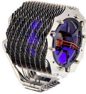
Resim 2.1: Yeni sistem işlemci soğutucusu örneği
