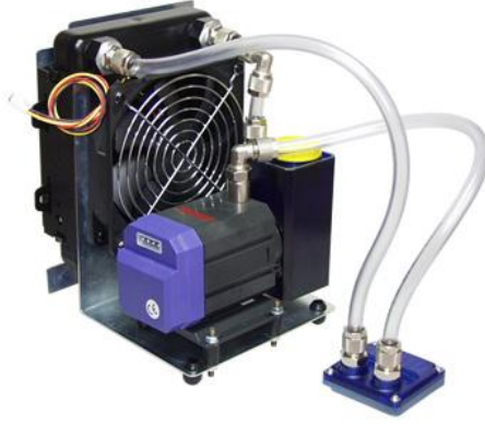
Resim 2.9: Su soğutmalı sistem
