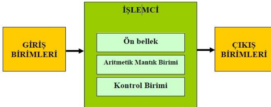
Şekil 1.1: İşlemci yapısı ve işlemcinin çevre birimleriyle ilişkisi
