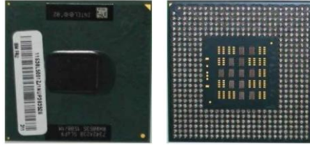
Resim 1.5: 478 pin FC-PGA paketi ön ve arka yüzü
