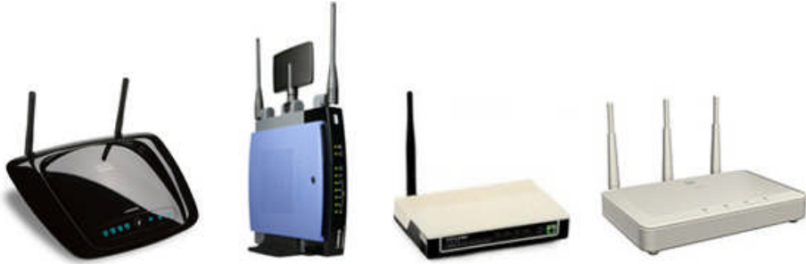
Resim 1.19: Kablosuz erişim noktası (Access Point - AP)
