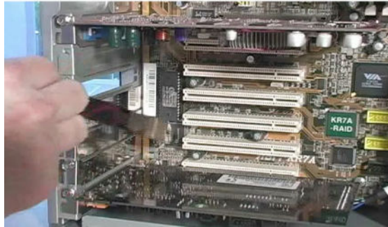
Resim 1.27: Metal plakanın çıkartılması
