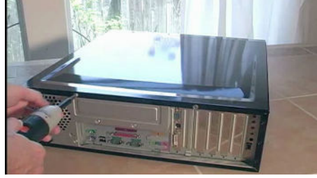
Resim 1.25: Kasanın açılması işlemi
