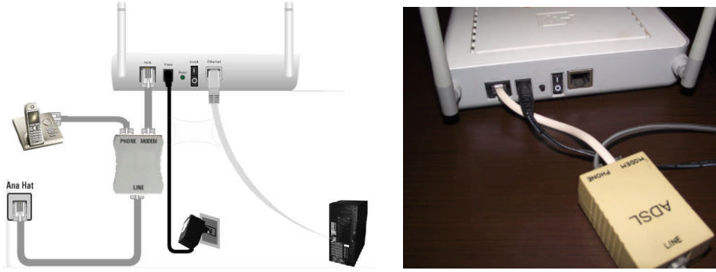
Resim 1.12: Kablosuz modem kablo bağlantısı
