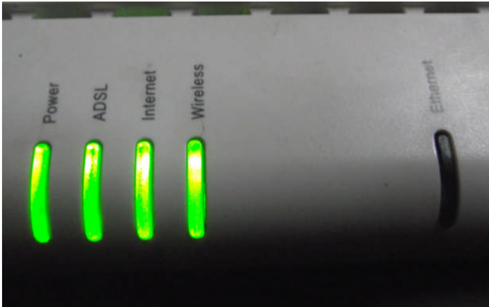
Resim 1.13: Kablosuz modem ön panel ışıkları
