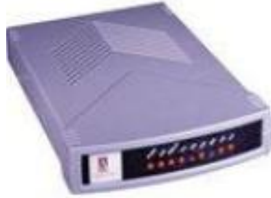
Şekil 2.8. Haricî (external) modem
