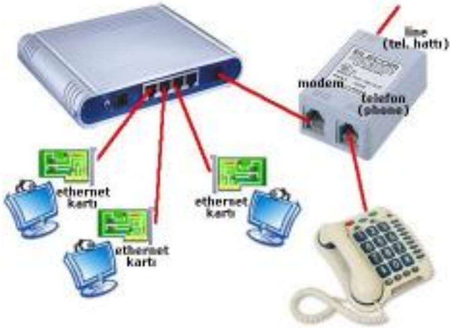
Şekil 2.10: ADSL modem bağlantı şekli
