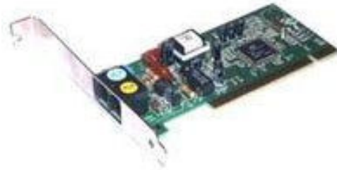
Şekil 2.7. Dahilî (internal) modem
