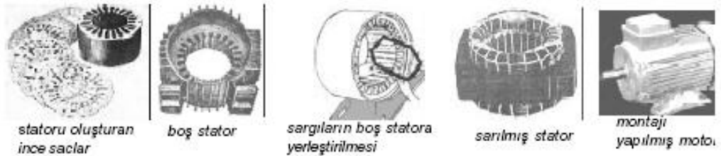
Şekil 1.4: DC-AC motorların gövdesi (statorları)
