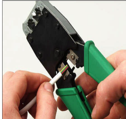
Resim 2.29: İletken tellerin kesilmesi
