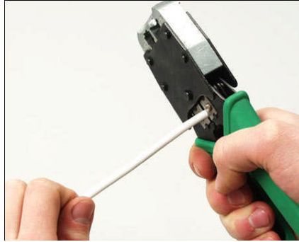
Resim 2.28: Telefon kablosunun soyulması
