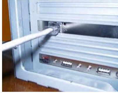
Resim 2.27: Bilgisayar kasası UTP kablo bağlantısı
