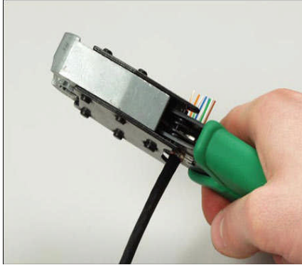
Resim 2.19: Kablo uçlarının kesilmesi
