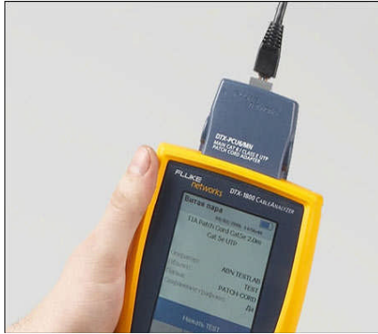
Resim 2.25: Kablonun test edilmesi
