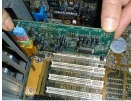
Resim 6.9: Ses kartının PCI slotuna takılması
