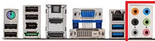
Resim 6.8: Tümleşik ses kartı bağlantıları
