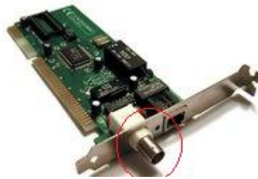
Resim 6.12: BNC Ethernet kartı
