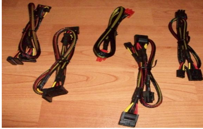
Resim 4.14: Güç kaynağı ek besleme kabloları
