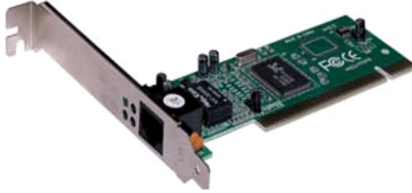
Resim 6.13: RJ45 giriřli ethernet kartı
