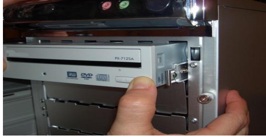
Resim 5.18: Optik okuyucu montajı
