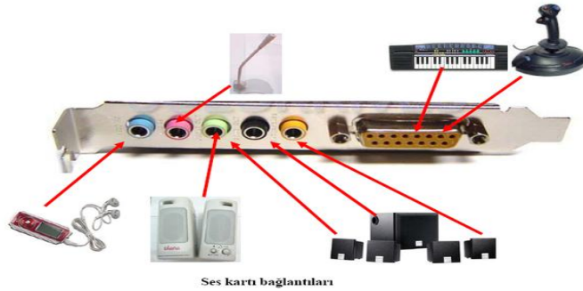
Resim 6.6: Ses kartı bağlantıları
